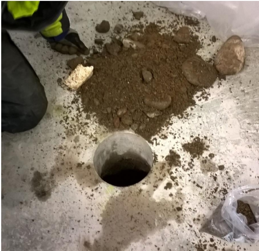
Kuva 1 Entisen pesuhallin betonilattiaan kairattu KP7, 0-0,5 m. Öljyhiilivetyjakeiden (C 10 - C 40 ) summapitoisuus ylitti kynnsarvon.
