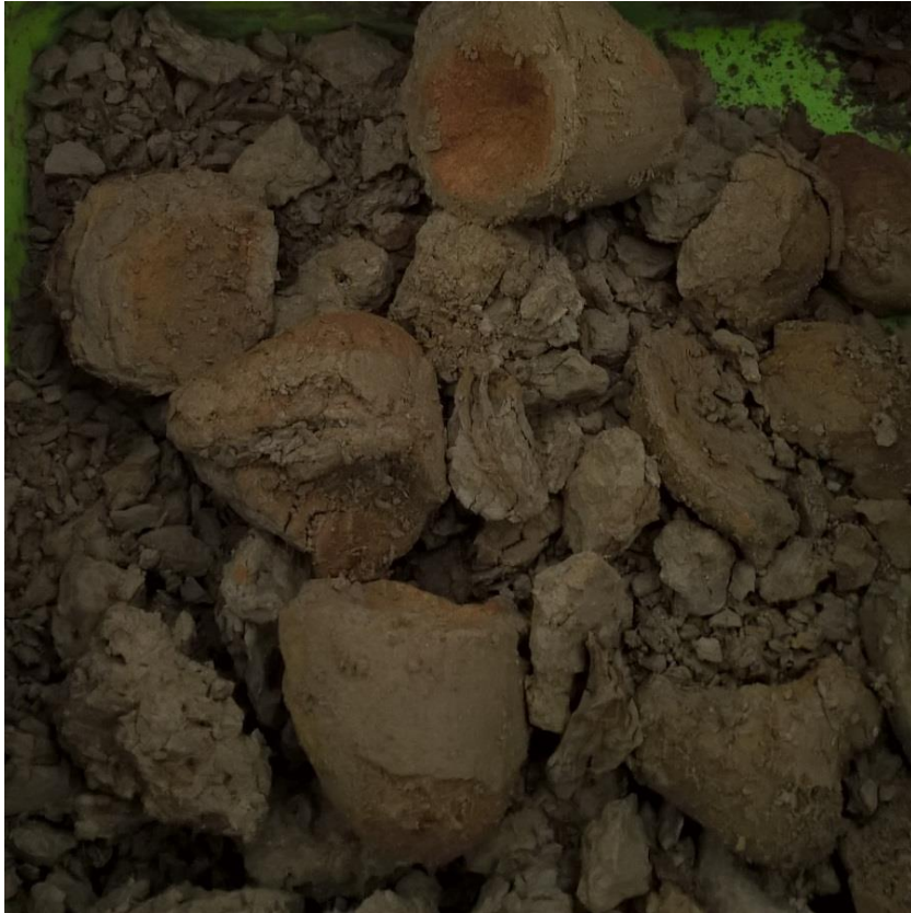
Kuva 3 Jussinpuistosta otettu KP1 syvyydeltä 0,6-1,2 m. Näytteen tuloksista selvisi koboltti (Co) kynnyksarvon ylitys.
